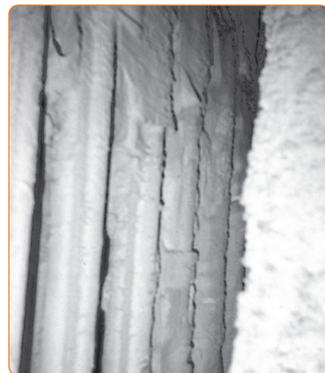
Рис. 1. Отложения золы на трубах котельного пучка
